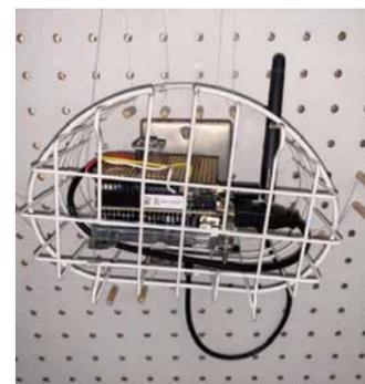
図5 開発したSigfox通信機能付きの照度センサー
