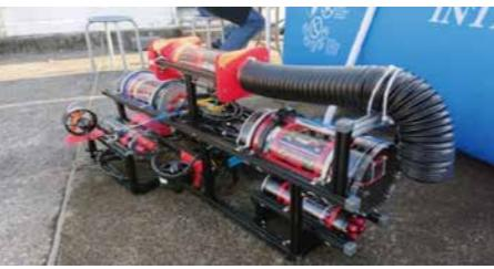
図3 クラゲ駆除装置を搭載した水中自律型ロボット
