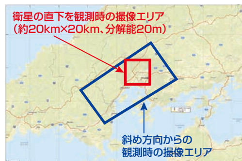
図2. 衛星の撮像エリア (高度約400kmからの観測、約20km×20km)
