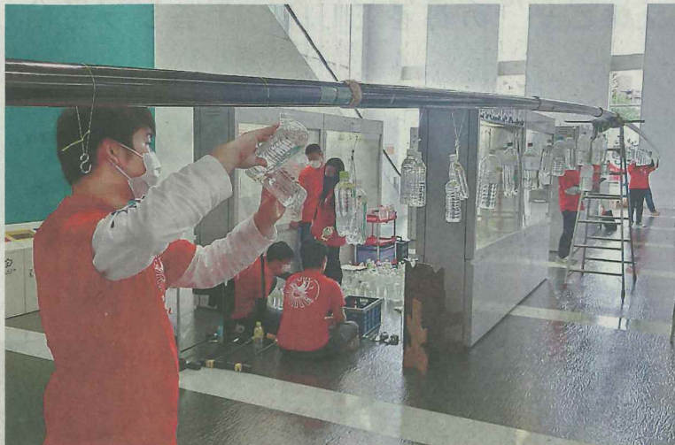
耐荷重の試験を公開する人力飛行機部の部員
