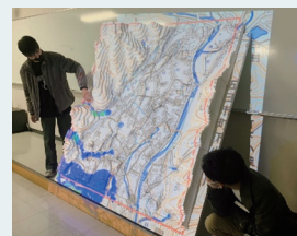
土石流シミュレーション結果を立体地図に投影している様子
